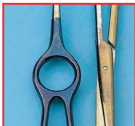
Scolorimenti su strumenti dovuti ad acido silicico
