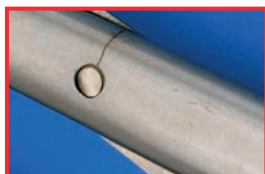
Incrinatura capillare nello snodo di un paio di forbici
