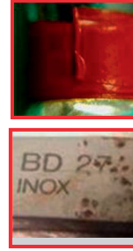
Pinzetta con corrosione perforante. Causa: il sovrainvecchiamento del nastro con funzione di codifica comporta il passaggio di sostanze dannose contenenti cloruri.
