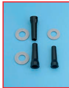
Destra: Guarnizioni gonfiate in seguito all'applicazione non mirata dell'olio per strumenti. Sinistra: guarnizioni nuove
