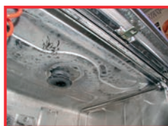
Camera di risciacquo con notevoli accumuli di calcare
