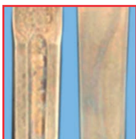
Superfici dell'impugnatura del bisturi con alterazione del colore
