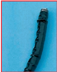
Rigonfiamento all'estremità distale di un fibroscopio
