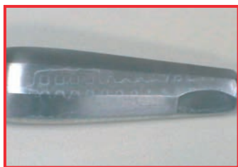
Trasporto residuo di sostanze detergenti a causa di un risciacquo insufficiente
