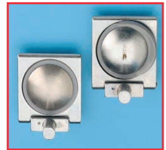
Destra: valvola di un tre quarti non a tenu- ta a causa del rigonfiamento della guarni- zione in seguito a contatto con dell'olio. Sinistra: valvola nuova
