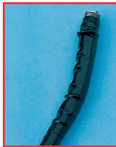
Rigonfiamento di un tubo d'inserzione dovuto all'utiliz- zo di una sostanza di manu- tenzione non idonea.
