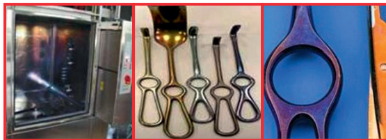
Tipici fenomeni di alterazione del colore del silicato all'interno della camera di risciacquo e sulla superficie degli strumenti per effetto di detergenti a base di silicati o di un'eccessiva percentuale di acido silicico presente nell'acqua.
