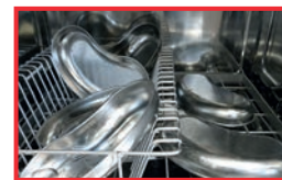
Macchina non caricata correttamente/bacinelle reniformi ribaltate
