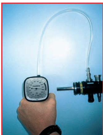
Test di tenuta su endoscopio flessibile
