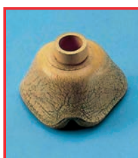
Fessura da invecchiamento su una maschera respiratoria
