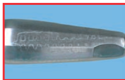
Impugnatura cava con presenza visibile di residui
