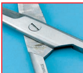
Corrosione da sfregamento per mancata lubrificazione
