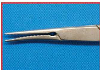
Deformazione in seguito a trattamento inadeguato
