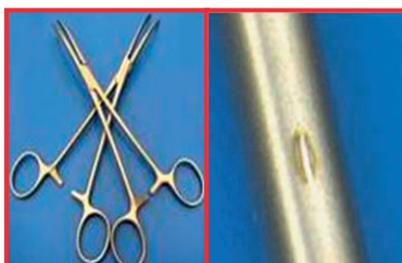
Corrosione da contatto: acciaio inossidabile/ acciaio inossidabile
