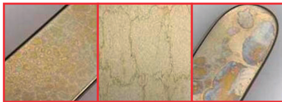
Tipici fenomeni di alterazione del colore del silicato sulla superficie degli strumenti in seguito a sterilizzazione a vapore per effetto di un'eccessiva percentuale di acido silicico presente nell'acqua completamente demineralizzata.
