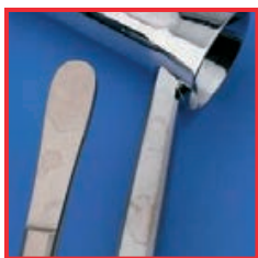
Macchie dovute a quantità elevata di sali nell'acqua di risciacquo
