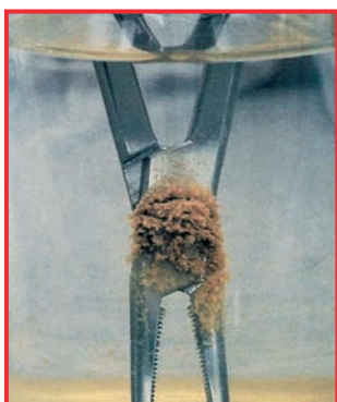
Formazione di ruggine dopo immersione prolungata in soluzione fisiologica di NaCl
