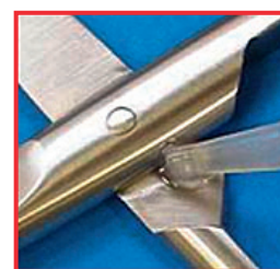
Per evitare questo fenomeno: effettuare una manutenzione mirata con olio per strumenti
